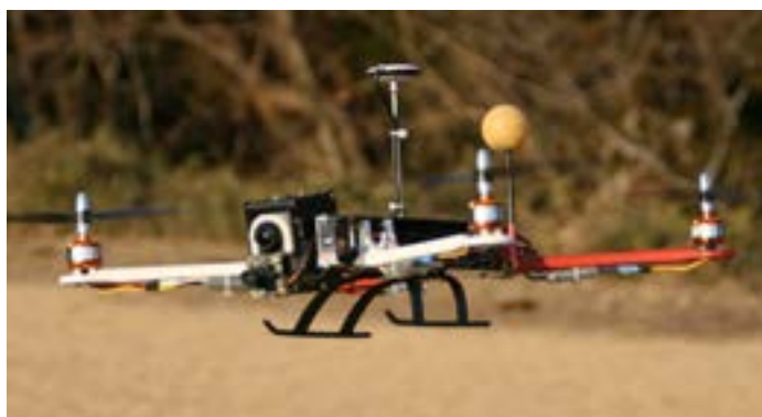
↑→桜井龍裕氏のマルチコプター。DJI製キットのアームを上下逆付けにして流用し、フレームは1mmカーボンを使用して自作した。カメラは、上下90°可変アングルのSONY製のアクションカムを搭載。アクションカム自体をシリコンダンパーで吊るし、下部をマグネットで吸着で半固定している。大きな振動はビデオ内部の手ブレ防止機能で除去できるが、高周波の振動までは取り除けないので、吊るす構造を採用した。総重量1100g。モーターピッチ間370mm。
