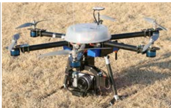
↑→須田徹氏のマルチコプターは、6基のモーターを搭載した空撮仕様。カメラ (SONY製 NEX5) は重量があるため、中央下の重心位置に搭載している。揺れに関してはジャイロとサーボモーターで制御し、細かい振動はスポンジ系素材で対応。また切り返し時の揺れは、自作の“ロータリー・ダンパー”が吸収している。モーター・アームは、ボイジャーのテールパイプを使用しているので剛性が高く、確実なレスポンスだ。
