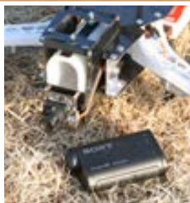
↑→桜井龍裕氏のマルチコプター。DJI製キットのアームを上下逆付けにして流用し、フレームは1mmカーボンを使用して自作した。カメラは、上下90°可変アングルのSONY製のアクションカムを搭載。アクションカム自体をシリコンダンパーで吊るし、下部をマグネットで吸着で半固定している。大きな振動はビデオ内部の手ブレ防止機能で除去できるが、高周波の振動までは取り除けないので、吊るす構造を採用した。総重量1100g。モーターピッチ間370mm。
